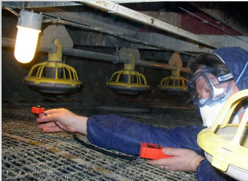
Måling av lyskilder i fjørfehus
