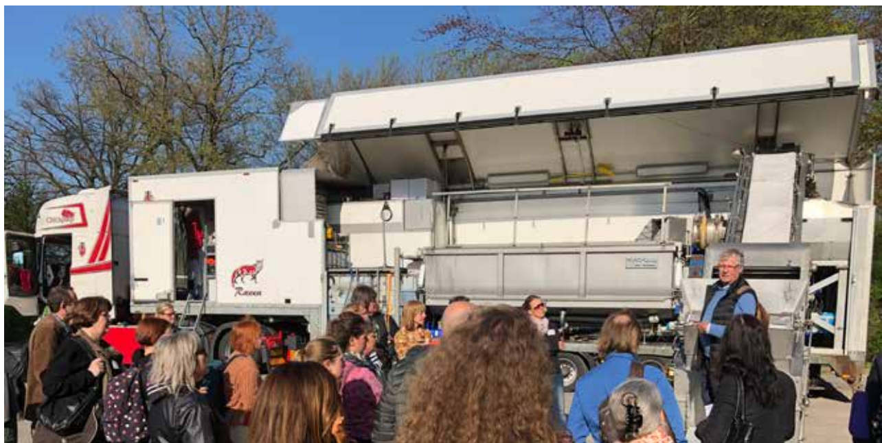
Her vises et spesialkjøretøy for avliving av høns og videre bearbeiding av plussprodukt. Hønsene blir bedøvet og avlivet ved to-fase karbondioksidsponering. Deretter kvernes de opp og tilsettes syre. «Pulpen» brukes som fôr til mink, dyrefôr og bioenergiproduksjon.
