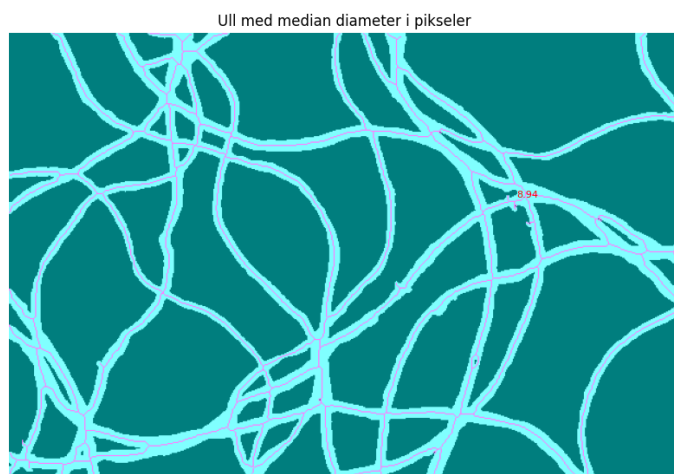
Figur 8. Mikroskopibilde av en ullprøve med skjelleteringslinjer og median diameter.
